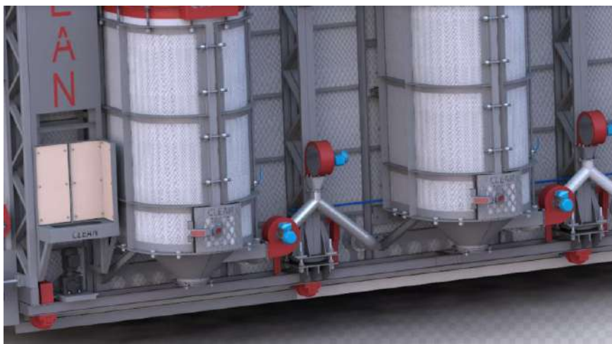
Figure 10 – Sistema de injeção de ar para queima de biomassa
